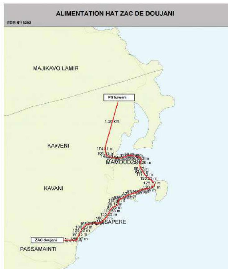
Figure 36 : Proposition d'alimentation HTA de la ZAC de Doujani (Source EDM)
