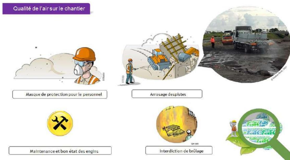
Figure 110 : Exemples de mesures pour améliorer la qualité de l'air sur le chantier (source Cyathea)
