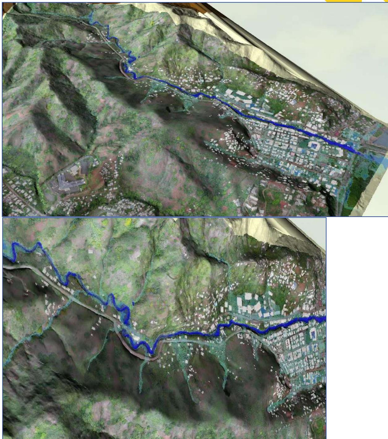
Figure 62 : Illustration 3D des écoulements d'une crue centennale de la rivière Mro Oua Doujani et ses affluents sur la zone d'étude (Etat initial)
