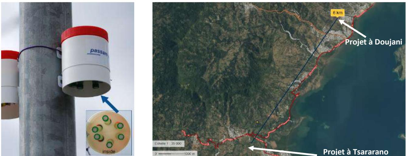
Figure 80: Dispositif de mesure du dioxyde d'azote utilisés sur un projet similaire à Tsararano
